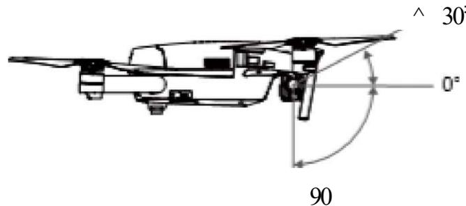
С помощью джойстика управления подвесом на лульте ДУ управляют: наклоном камеры или перейдите к пункту «Camera View» в приложении DJI GO 4 коснитесь экрана и удерживайте его, пока не появится синий круг, затем поверните его, чтобы управлять наклоном камеры. Управляемый диапазон оси подвеса камеры составляет с 0° до 30°, что позволяет снимать в ландшафтном и портретном режимах. При включенном режиме портретной съемки ось вращения будет повернута на 90°.
